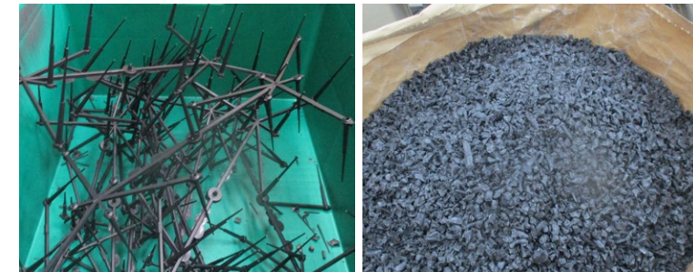
射出成型工程で発生する樹脂廃材を粉砕し、再生材として使用
